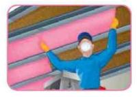
8.- Es importante que el material se expanda completamente para obtener el aislamiento apropiado. La barrera de vapor, en caso de ser necesario, debe ir hacia el área más cálida en invierno.
