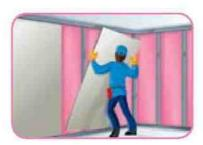
7.- El aislamiento al instalarse debe ser protegido con un material aprobado como paneles de yeso. En climas templados donde raramente se tienen temperaturas bajo 0°C, no se necesita una barrera de vapor.
