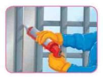
2.- Selle cualquier ruptura o agujero alrededor del piso, techo o pared, solera superior e inferior y detrás de cajas de empalme por donde pueda haber penetración de aire con sellante adhesivo.
